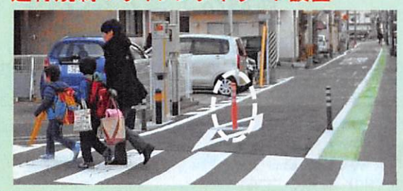
通行規制＋ライジングボラード設置
