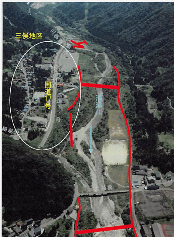
清津川沿いに立地する集落（三俣地区）や国道17号等を保全するため、溪流保全工を整備します
