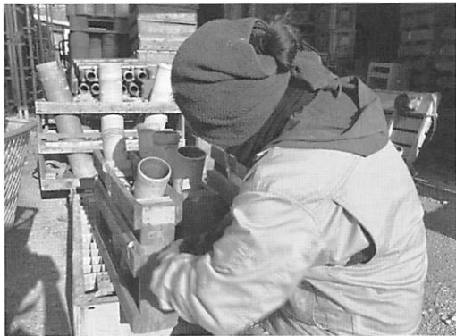
火薬の配置や量だけでなく、筒の角度も狂いなく、統一しなければならない。
