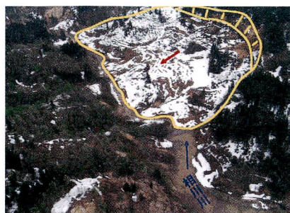
①相川川を閉塞した小高田麦山地区の地すべり 小千谷市 (H17.5.6撮影)
